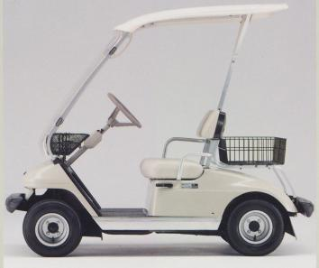
●始動・発進・停止もワンタッチ操作スイッチを入れてアクセルを踏むとエンジンが始動するアクセルオートスターターを採用。このとき同時にパーキングブレーキも自動解除。さらにブレーキ上部を踏みながらブレーキングすると停止後、自動的にパーキングブレーキが作動。また停止後、エンジンも止まる親切設計です。
